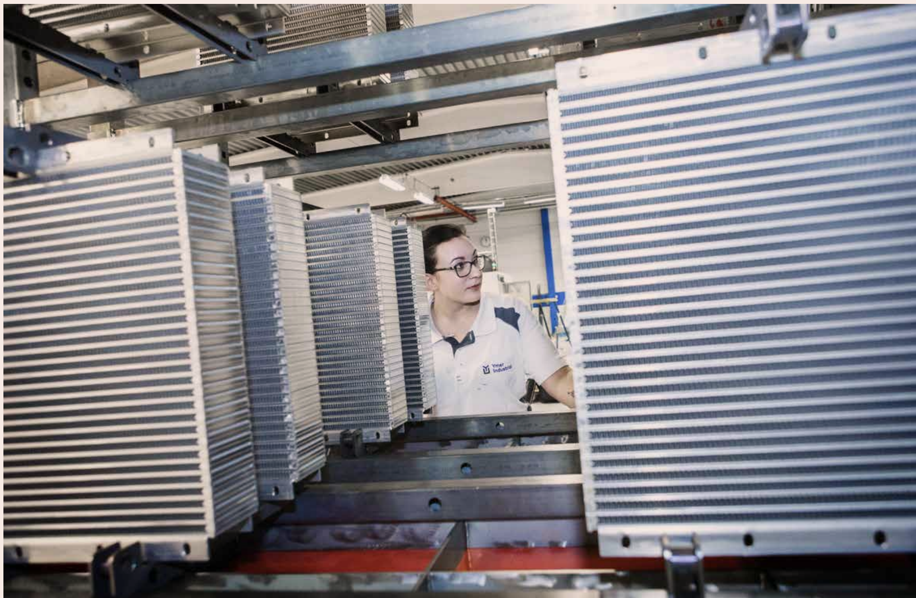
FÖR SNABBARE LEVERANS. Nicolina Jansson på Ymer Technology i Ljungby förbereder kylkomponenter för lödning i en stor ugn. Företaget har flyttat tillverkning från Kina till Sverige i år.
